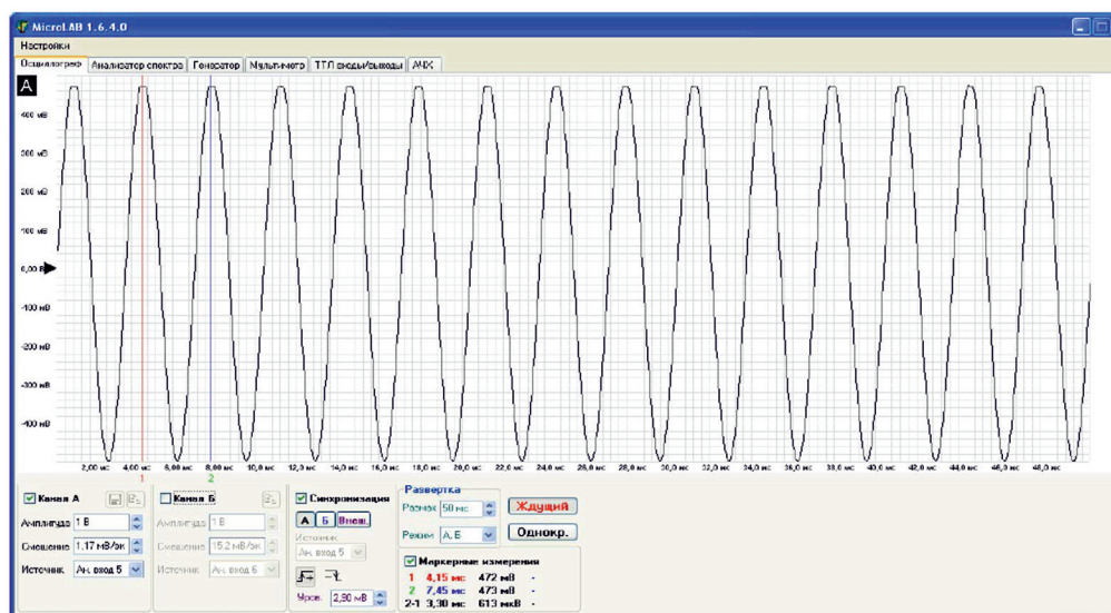
Рис. 3. Осциллограмма вынужденных электромагнитных колебаний
