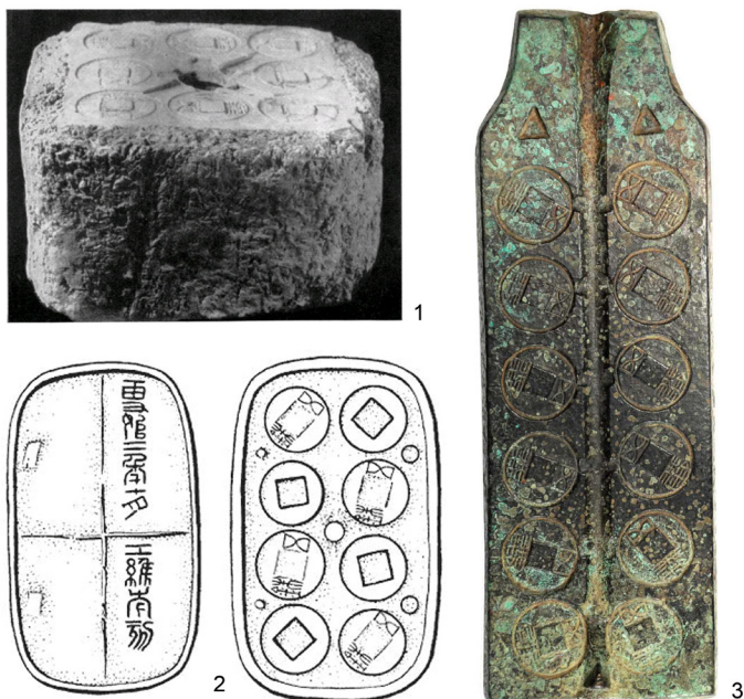
Рисунок 4. К вопросу о технологии изготовления китайских литейных форм: 1 – матрица в камне (по А.А. Быкову); 2 – глиняная литейная форма рубежа н. э. (по М. Лёве); 3 – матрица для оттискивания литейной формы в глине (из архива «Stack's Bowers Galleries»).
